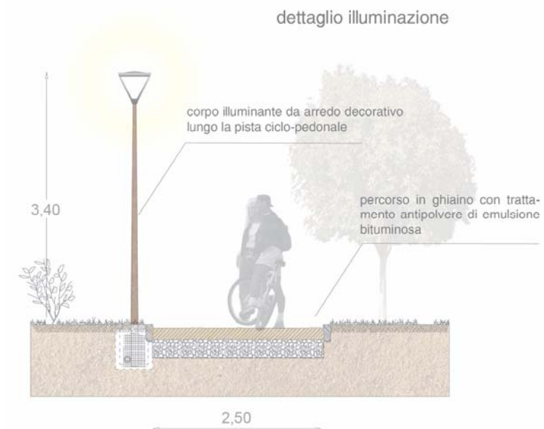
Figura 81: sezione tipo della pista ciclopedonale all'interno del parco della Valletta (V. TAVOLA ALLEGATA 3.7.4)
